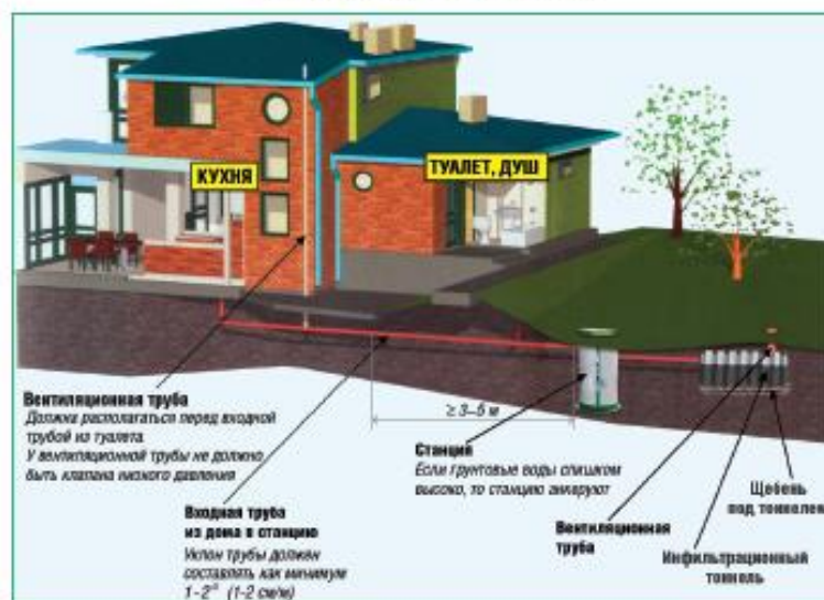
Рис. 2 Схема установки станции FloTenk-BioPurit
