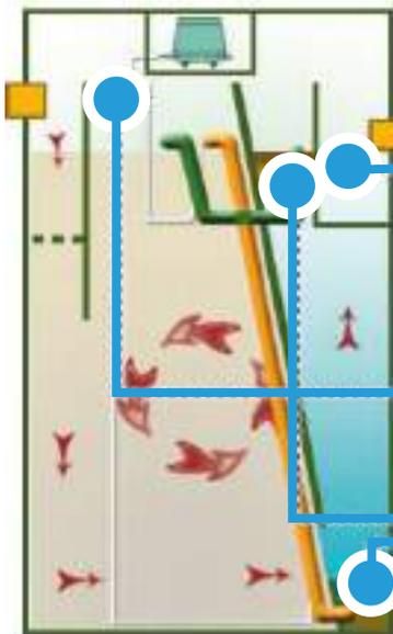
Камера сброса по умолчанию самотёчная. В неё может быть засыпан фильтрующий материал, который может дополнительно повысить качество очистки сточных вод до 2 раз. Так же в камере может быть установлен насос принудительного выброса очищенной воды, комплект для подключения насоса поставляется в комплекте со станцией.
