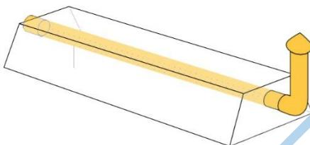
Дренажный элемент представляет собой ёмкость формы усеченной пирамиды без дна, располагающейся на подушке из щебня. Через всю длину проходит дренажная труба, посредством которой самотеком сбрасывается вода.
