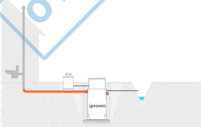
**ВАРИАНТ 3.** Монтаж самотёчной станции «КОЛОС» с отводом очищенных бытовых сточных вод в фильтрующий колодец.
