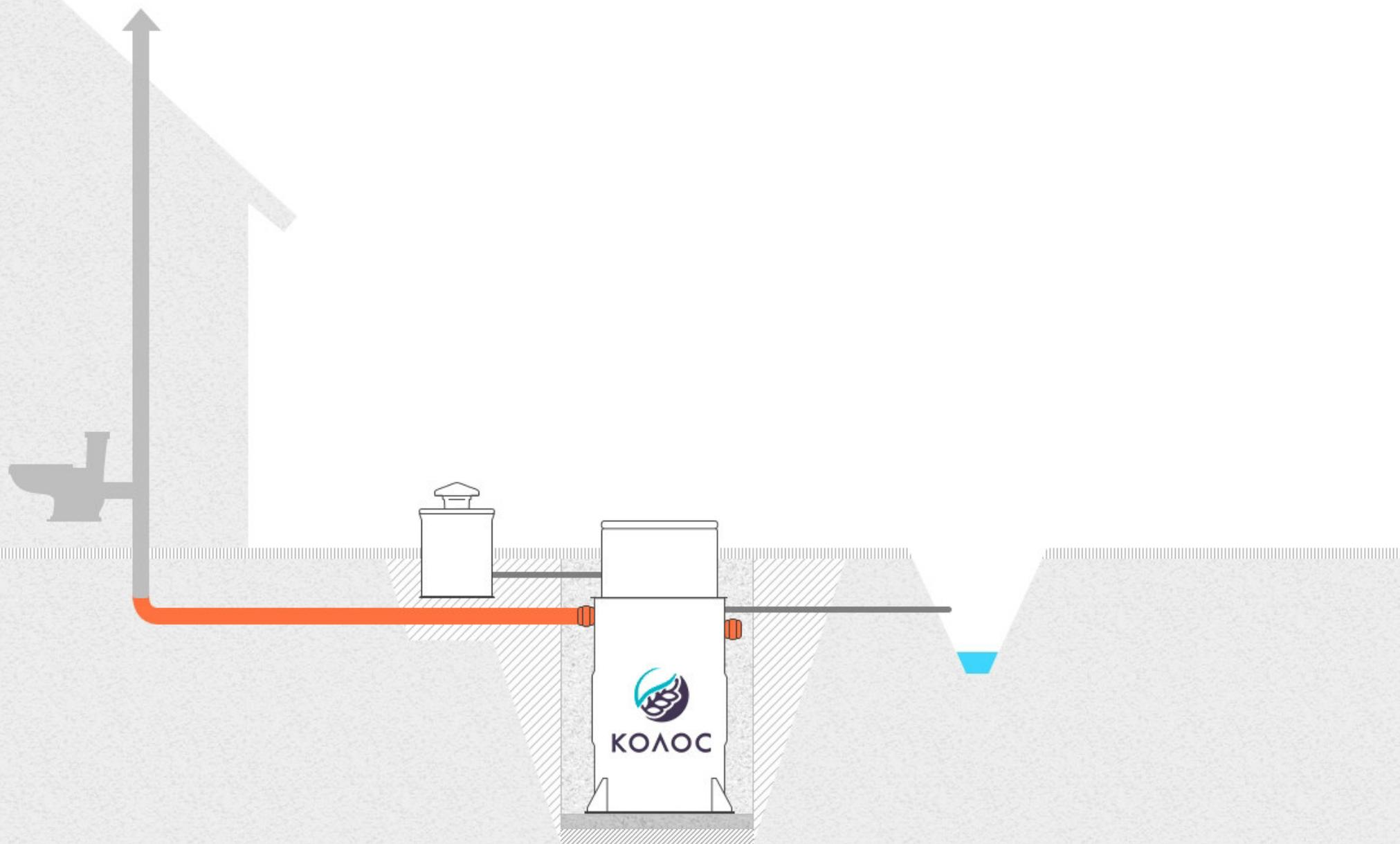
**Монтаж самотёчной станции «КОЛОС» с отводом очищенных бытовых сточных вод в фильтрующий колодец.**
