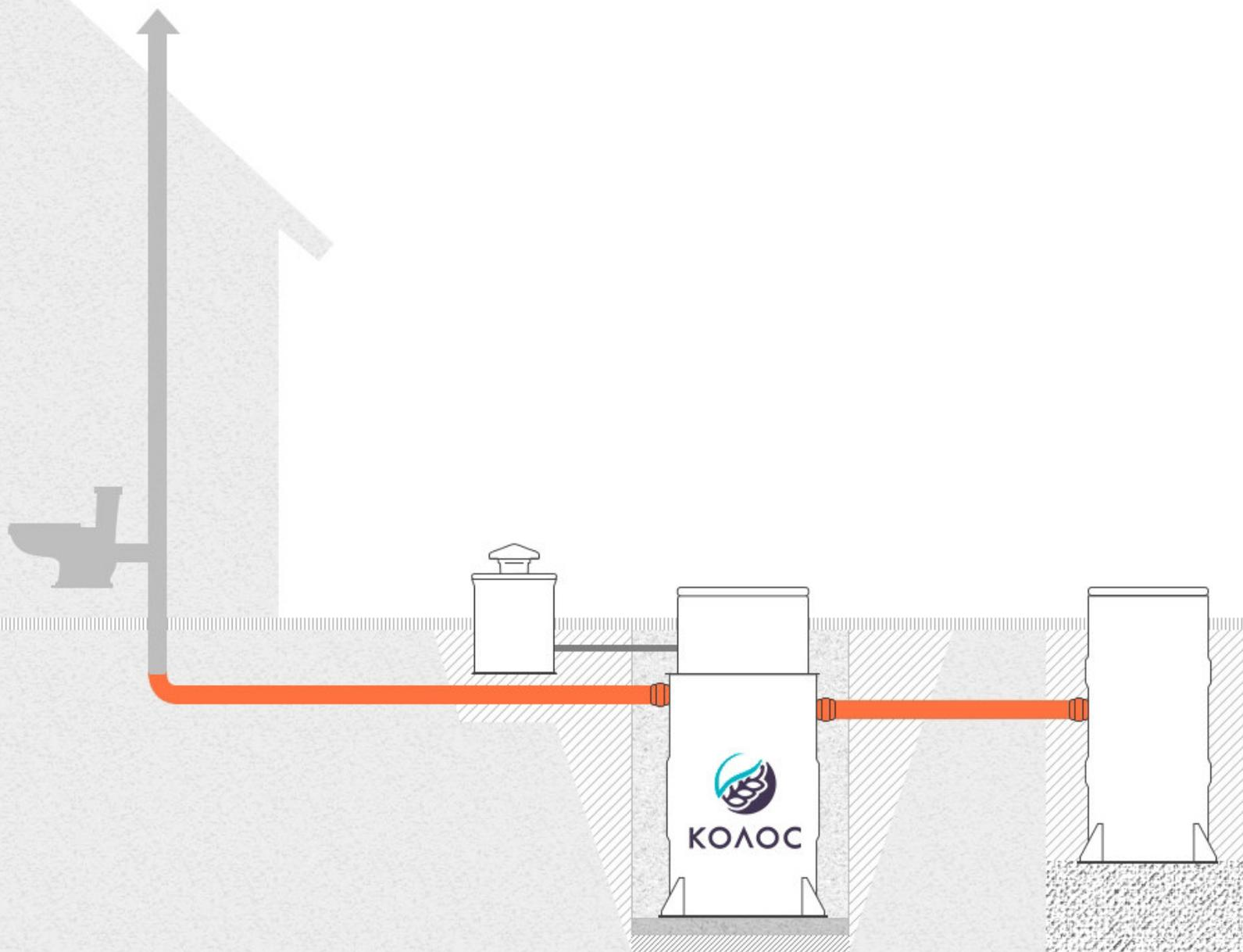
**Монтаж самотёчной станции «КОЛОС» с отводом очищенных бытовых сточных вод в дренажное поле фильтрации.**
