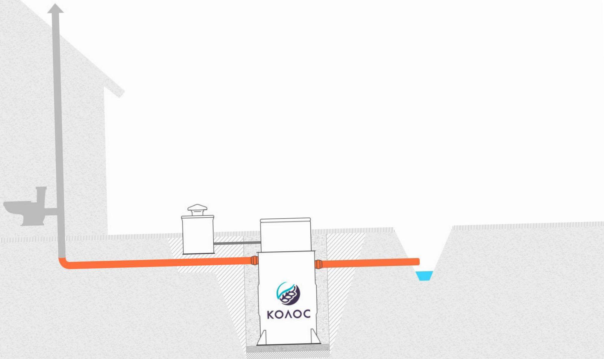
**Монтаж станции «КОЛОС» с принудительным отводом сточных вод в дренажную канаву.**
