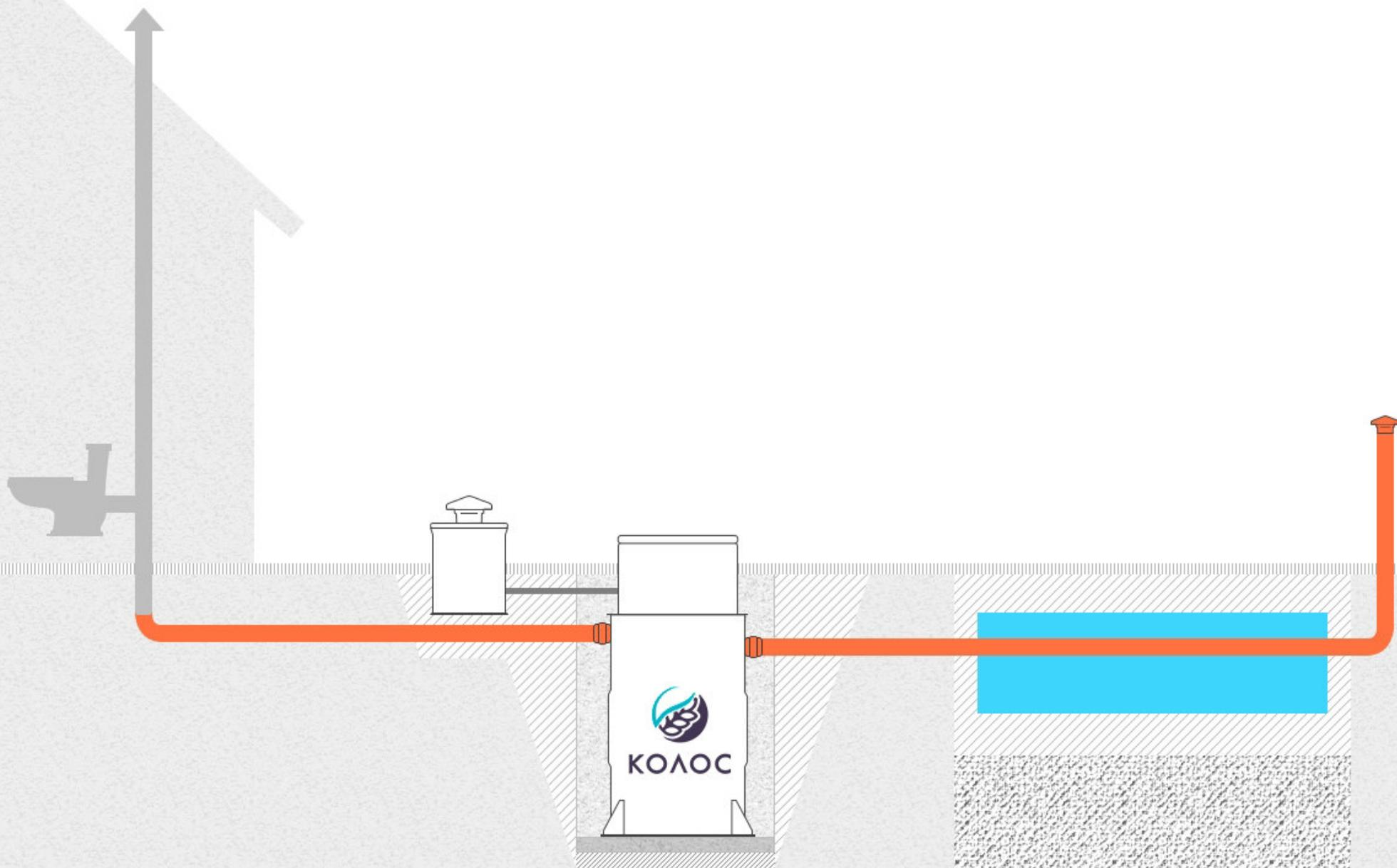
**Монтаж станции «КОЛОС» с принудительным забором бытовых сточных вод из приёмного колодца.
