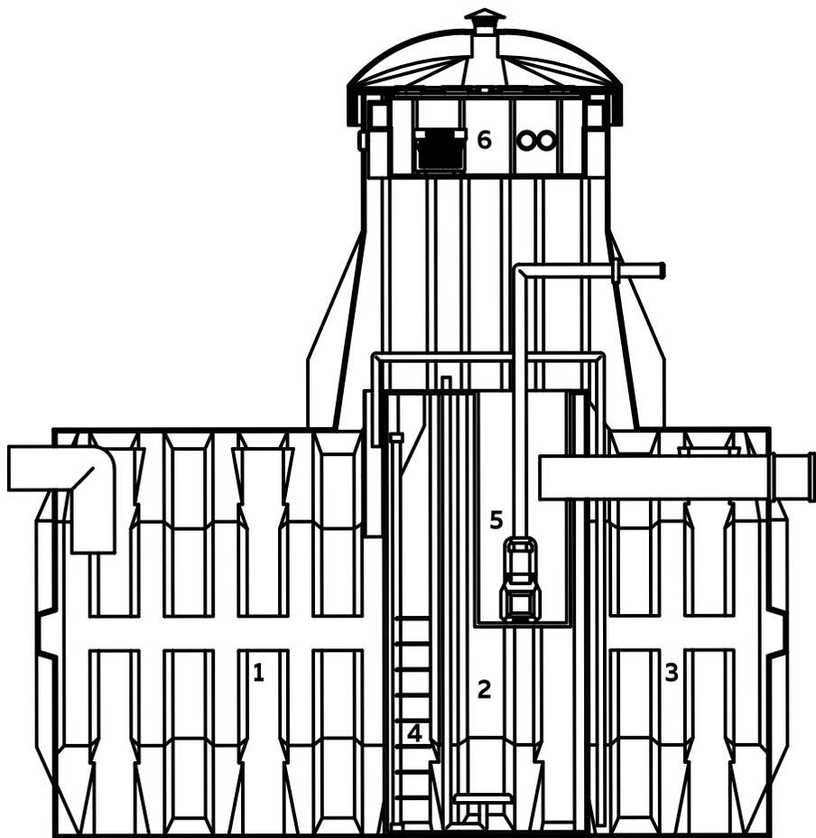
1. Приемная камера, 2. Эрлотэнк, 3. Камера гравитационного осаждения активного ила, 4. Волосоуловитель, 5. Блок-успокоитель очищенной воды, 6. Блок управления
