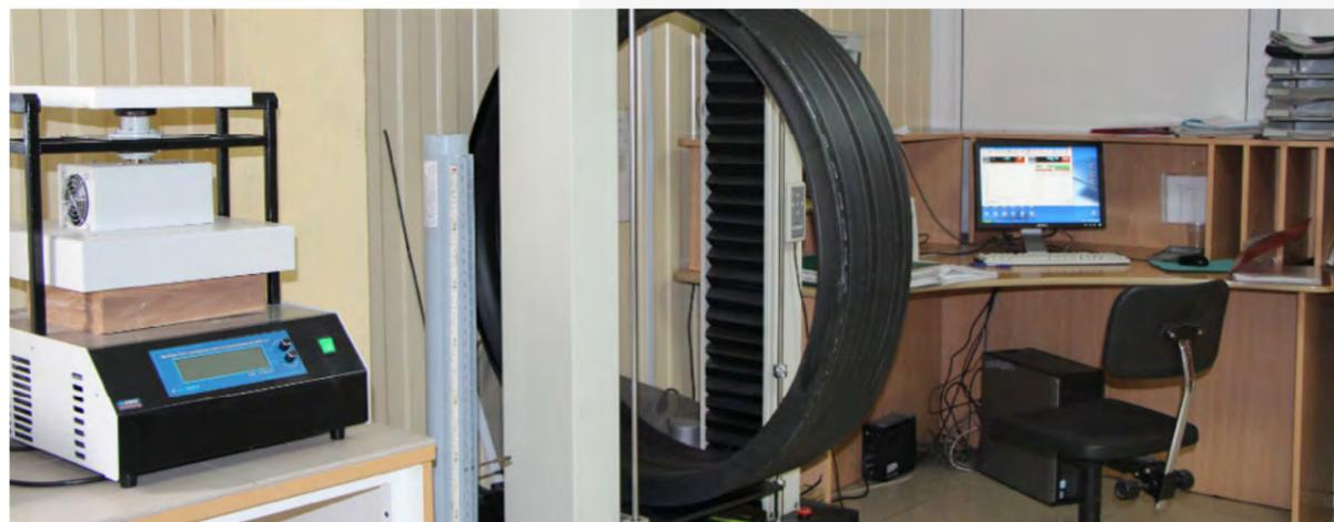
Конструкция профиля обеспечивает высокую сопротивляемость деформации. Трубы сохраняют высокую прочность и при отрицательных температурах, их применяют даже в сейсмоопасных районах, где нередки землетрясения, и как следствие, дополнительные подвижки грунта. Только этих характеристик уже достаточно для достижения поставленной цели, но у спиральновитой ПНД трубы есть еще несколько ощутимых преимуществ:
