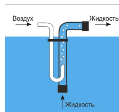
ки, а вода самотеком уходит обратно в одну из камер станции. Из-за того, что все твердые фракции удаляются с помощью эрлифта, СБО вообще не нуждается в откачке иловых осадков, что делает данную станцию довольно удобной в эксплуатации, единственное, что нужно делать, это один раз в 1-2 месяца опорожнять корзину с илом, обычно это занимает 5-7 минут.
